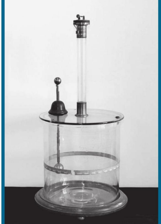
Balanza de torsión utilizada para determinar la ley de Coulomb. Las cargas eléctricas generan una fuerza de torsión que es medida según el ángulo de torsión formado.
