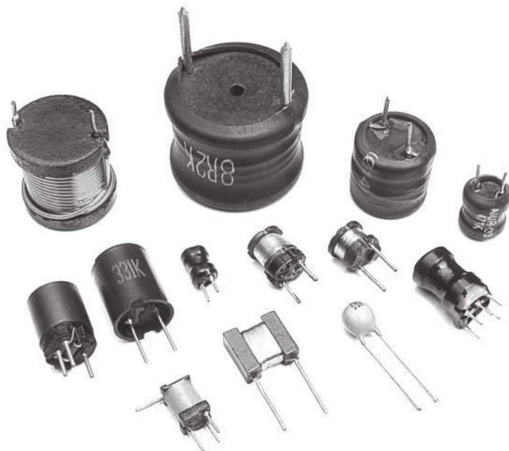
Distintos tipos de inductores que están conformados en su interior principalmente por bobinas de cobre, aluminio u otras aleaciones aisladas entre sí.
